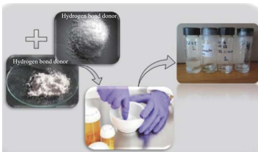
图 1 研磨法制备低共熔溶剂 [15]
