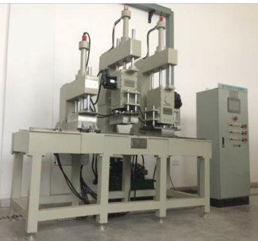
图 1 多工位大曲成型实验台 Fig.1 Multi-station Daqu forming experiment platform 注: 1. 机架; 2. 锤头; 3. 压力传感器; 4. 伺服电机; 5. 凸轮; 6. 传动轴; 7. 液压缸; 8. 位移传感器; 9. 导向轴; 10. 模盒定位机构; 11. 模盒。
