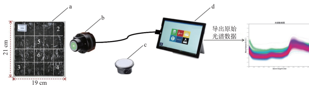
图1 近红外光谱采集装置图
