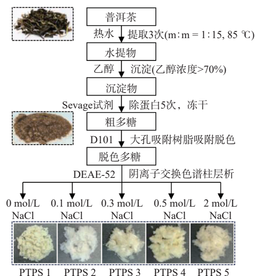
图 1 PTPS 的提取和分离纯化流程
